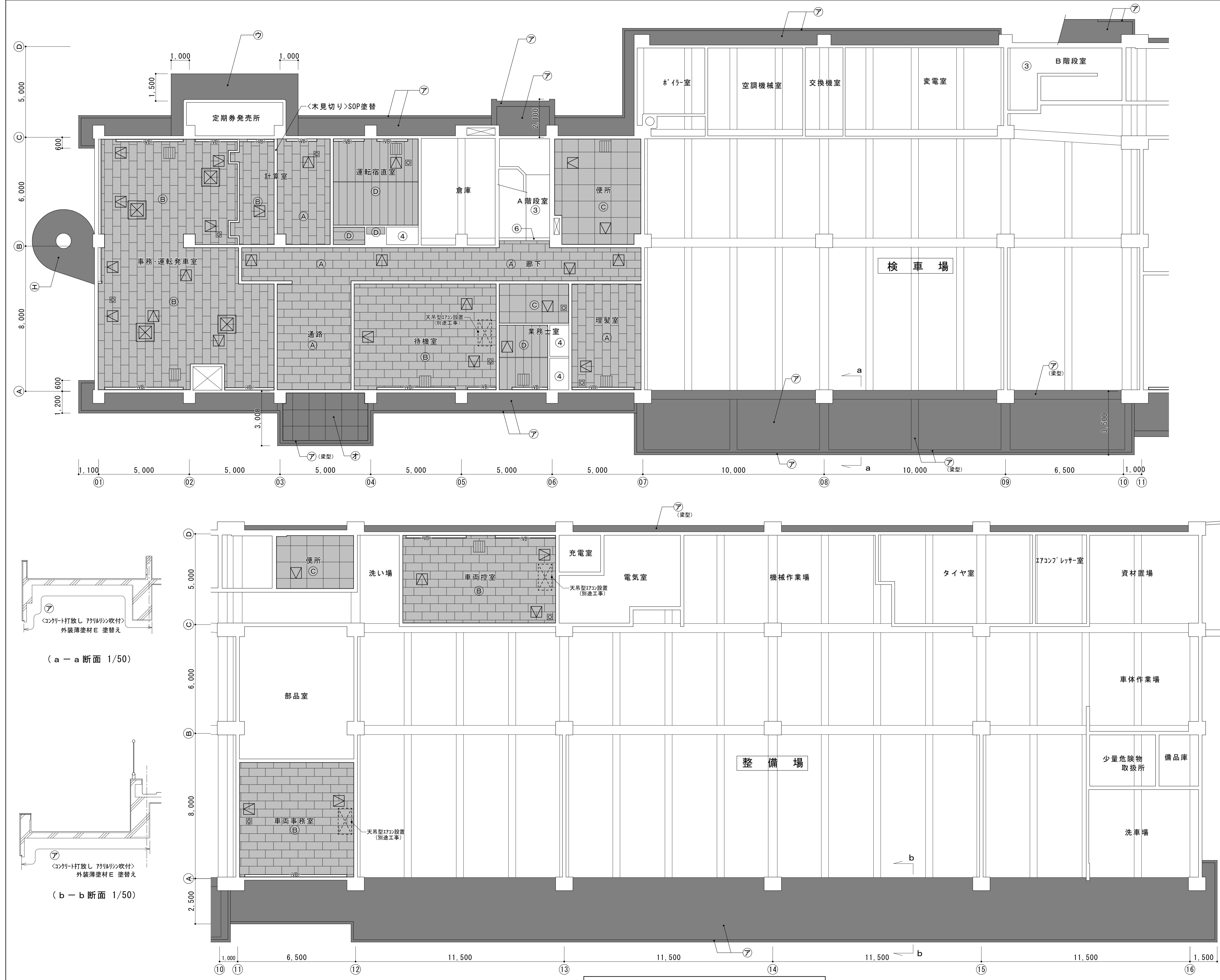
（改修後）1階 天井伏図 S=1:100
